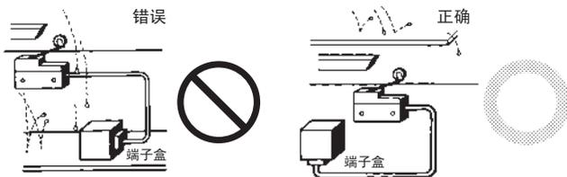
● 请将开关安装在不会直接接触到切屑或尘埃的位置。必须保证驱动杆和开关本体上不会堆积切削屑和泥状物质。
