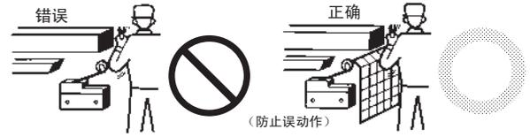
● 开关受到连续的振动和冲击时，产生的磨损粉末可能导致接点接触不良和动作失常、耐久性下降等问题。过大的振动和冲击可能导致接点误动作或损坏。因此请将开关安装在不会受到振动和冲击的位置，以及不会发生共振的方向上。
