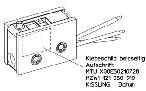
Mechanische Daten Schaltkraft \_\_\_\_\_\_ 3 bis 5,1 N Rückschaltkraft ..... \_\_\_\_\_ > 1 N Elektrische Daten
