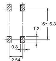
\* 外形尺寸与标准SOP 4引脚的外形尺寸不同, 但安装板尺寸相同。
