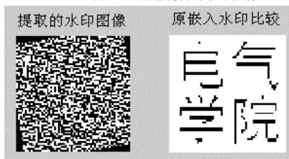
图 4.9 从被旋转过的水印图像中提取出水印图像与原始图像对比图
