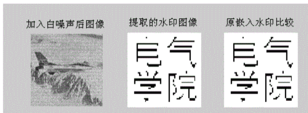
图 4.4 加入白噪声之后的图像提取出来的水印与原始水印比较
