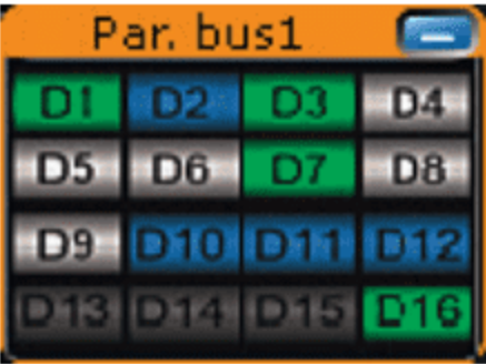
数字通道的信号状态在信号栏显示，与示波器设置无关。
